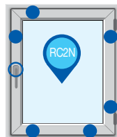
Varnostno okno RC2N (42 mm troslojno steklo) z dodatnimi varnostnimi elementi
