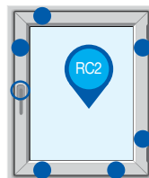
Varnostno okno RC2 (varnostno lepljeno steklo P4A) z dodatnimi varnostnimi elementi
